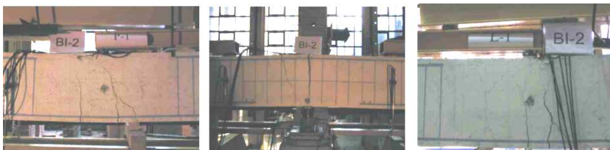
Rys. 10. Obraz zniszczenia belki BI-2 w przekrojach charakterystycznych.
