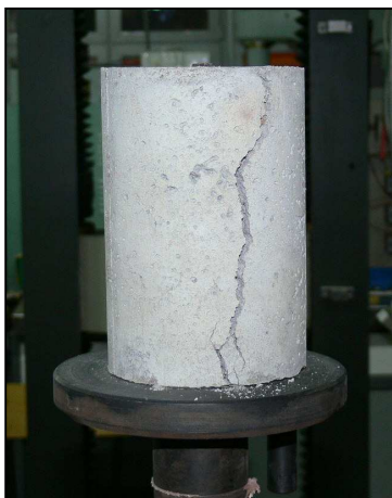
Rys.3. Badanie „na zimno” - przykład typowego zniszczeni. Stal A, temperatura 700°C.
