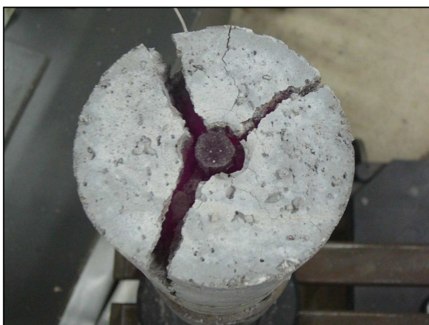
Rys.4. Badanie „na gorąco” – przykład typowego zniszczenia. Stal C EPSTAL ® , obciążenie 12 kN.
