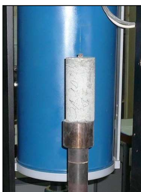
Rys.1. Badanie „na gorąco” – widok próbki przed badaniem. W tle cylindryczny piec, w którym umieszczana jest próbka.
