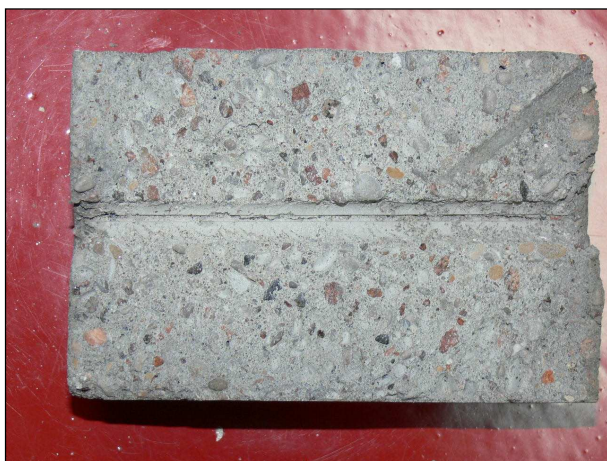
Rys.2. Przykład próbki po badaniu z widocznym kanalikiem, w którym umieszczona została termopara mierząca temperaturę na styku zbrojenie – beton.
